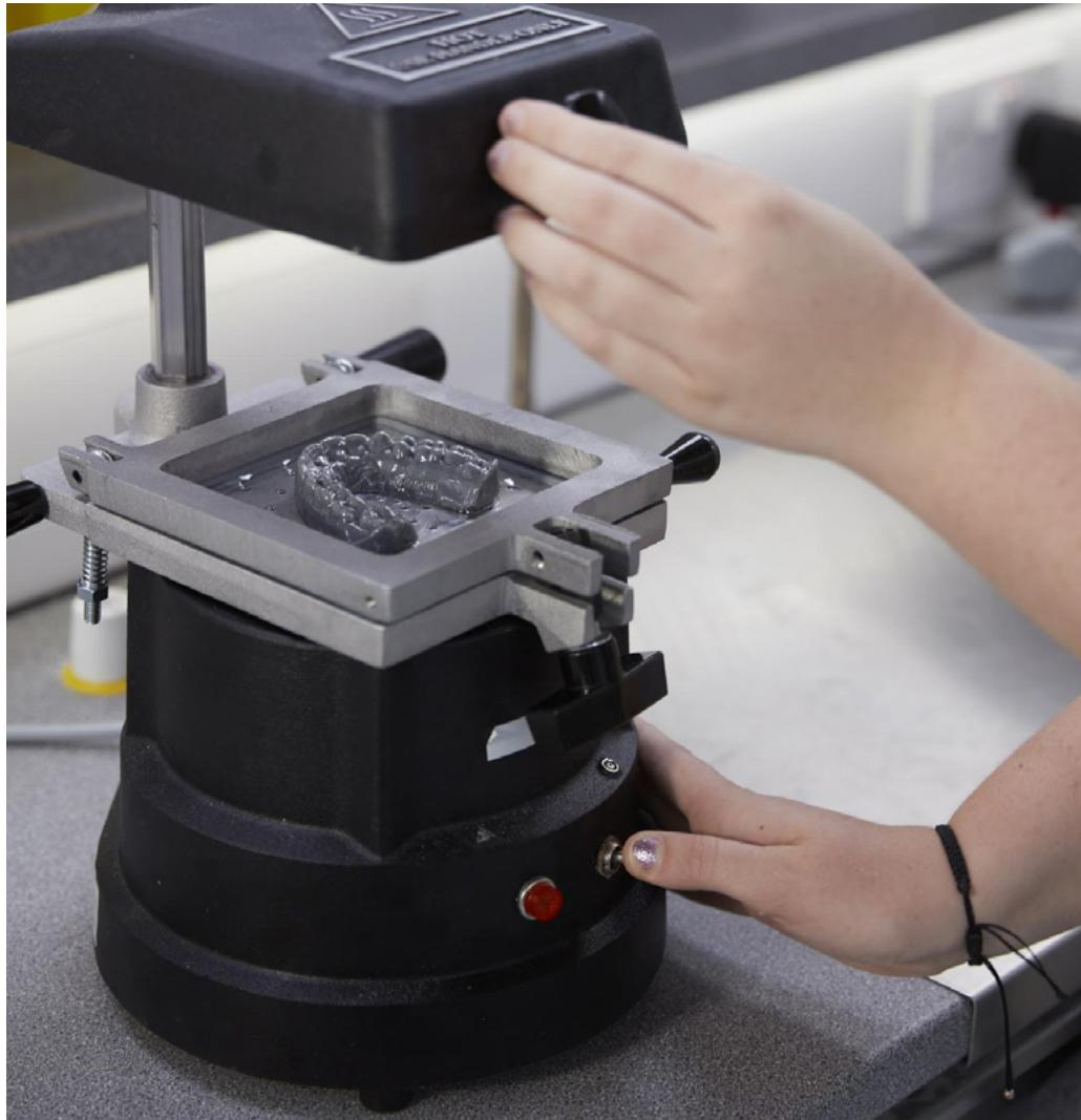
**Attention !** Selon le matériau utilisé pour les aligneurs, si la base du modèle est trop grande, les parois des aligneurs produits seront trop minces. Assurez-vous que les modèles générés ne soient pas plus grands que les préconisations du fabricant. En général, les fabricants recommandent de ne pas dépasser une hauteur de modèle de 19 mm.
