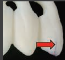
Fissure s'étant produite lors de la pressée
