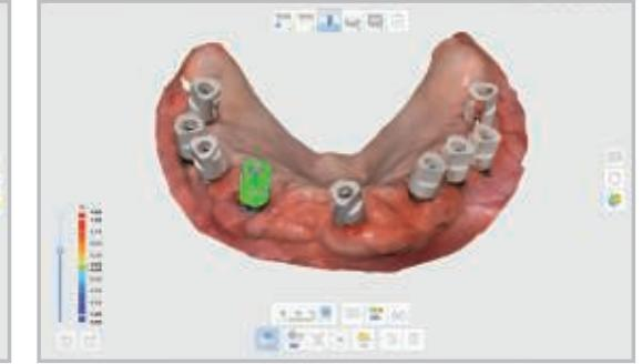
Les scanbody et faux moignons sont alignés automatiquement avec les données de numérisation. Utilisez cette fonction pour des travaux en aval tels que la conception. CAD.
